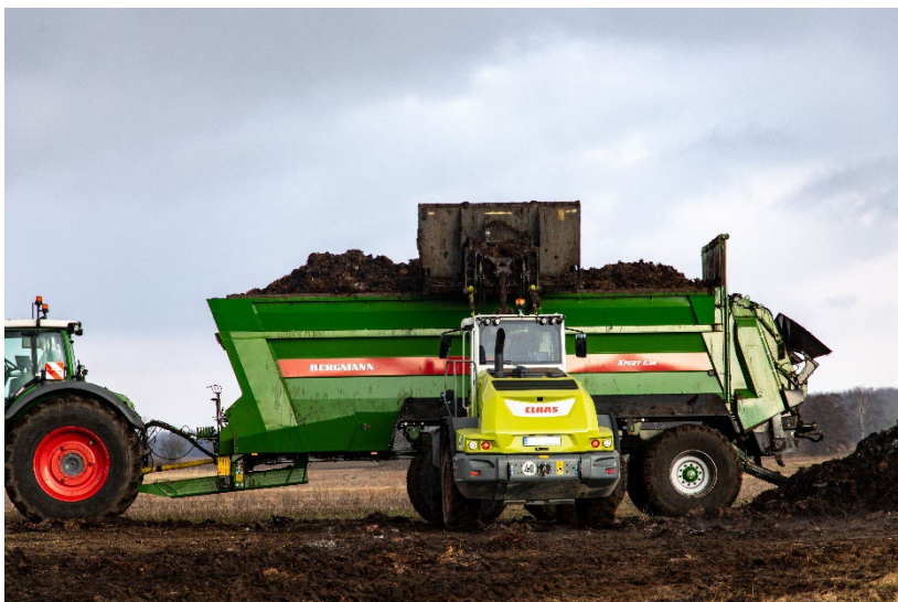
Afb.: Praktische lengte van de laadruimte, hier met de BERGMANN XPERT 6.34 als voorbeeld: drie bakbreedtes passen bij het laden naast elkaar.
