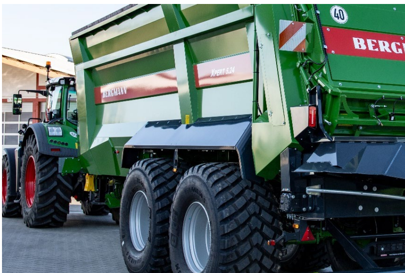
Afb.: De steile spatborden met KTL- en poedercoating voorkomen betrouwbaar dat grotere stukken materiaal gaan vastkleven. Ook de contouren van de zijwanden bieden geen ruimte voor afzettingen van strooimateriaal.
