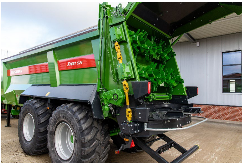
Afb.: Alle BERGMANN XPERT-modellen zijn standaard uitgerust met een cardanische aandrijving: onderhoudsarm en met een zeer rustige loop.
