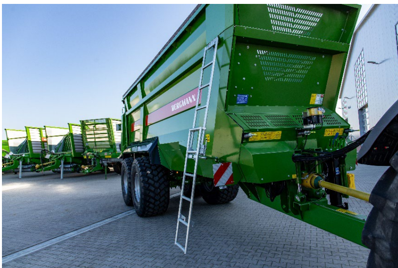
Photo : L'échelle d'accès s'applique à l'oblique pour une montée ergonomique.
