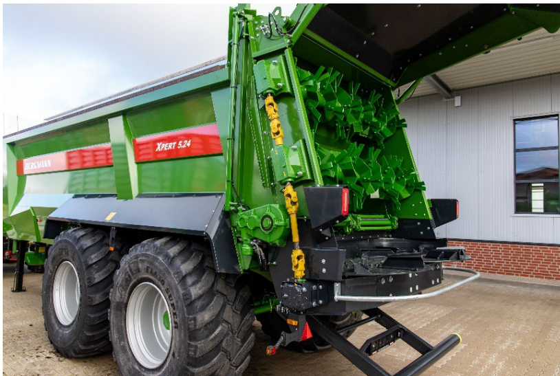
Photo : Tous les modèles BERGMANN XPERT sont équipés de série d'un entraînement à cardan. Cela réduit les besoins d'entretien et permet un fonctionnement très silencieux.
