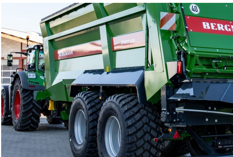
Photo : Les garde-boue fortement inclinés et revêtus par cataphorèse et par poudrage empêchent fiablement d'importantes adhérences de matière. Les contours des parois latérales, également, empêchent les dépôts de matière d'épandage.
