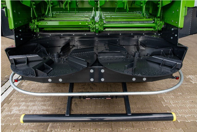
Photo : Diamètre de 1 100 mm sur un BERGMANN XPERT 5.24 avec T-Spread, pour une qualité de distribution encore améliorée. La table d'épandage V-Spread a toujours un diamètre de disque de 1 100 mm.
