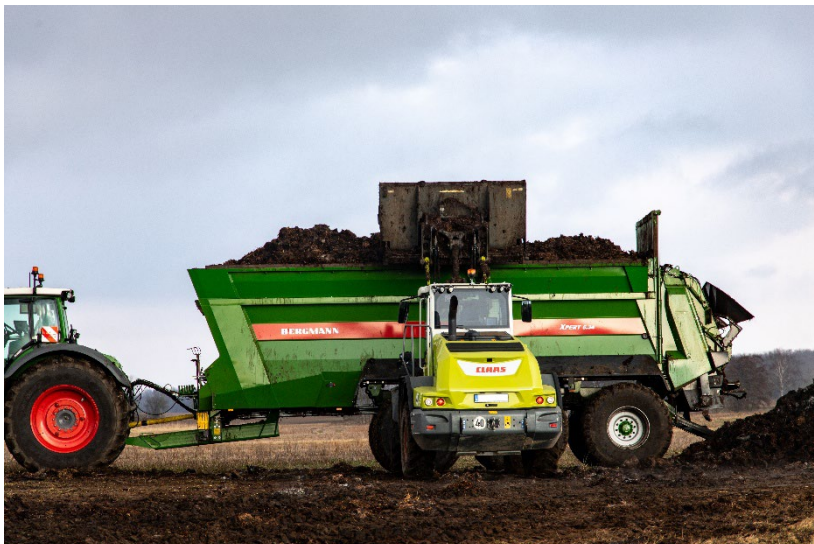
Photo : Des longueurs de l'espace de chargement répondant aux besoins pratiques à l'exemple du BERGMANN XPERT 6.34 : trois largeurs de godet tiennent côte à côte lors du chargement.
