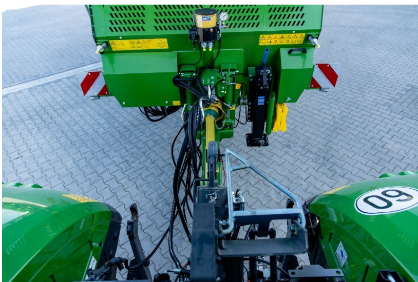
Photo : Peu d'endroits où la saleté peut s'accumuler. L'étroit timon rend tout attelage avec les modèles XPERT extrêmement agile.
