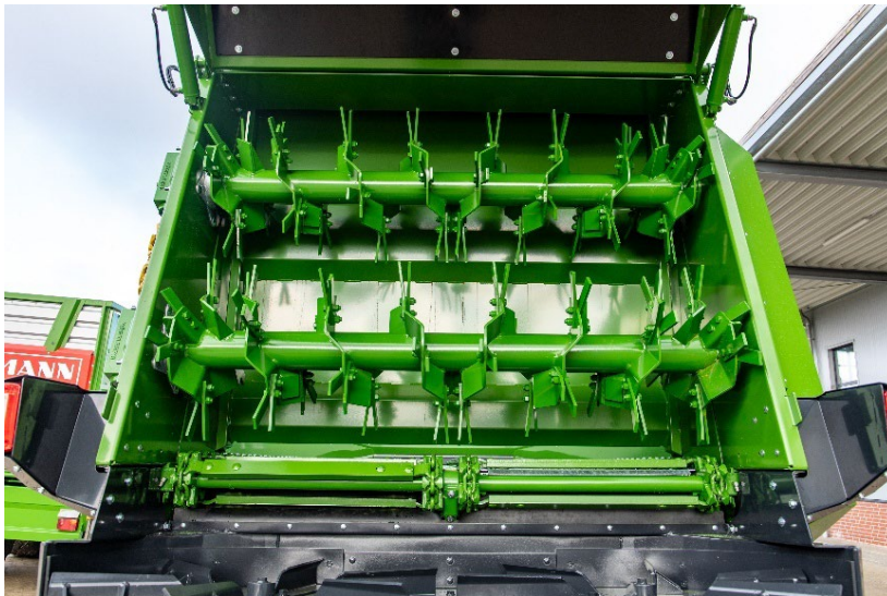
Photo : dispositif de fraissage à 2 hérissons avec passage de 1,70 m
