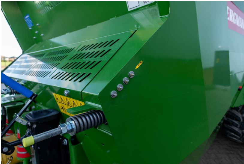
Photo : des points de graissage rassemblés, ici à l'avant, pour la redirection des chaînes du fond mouvant
