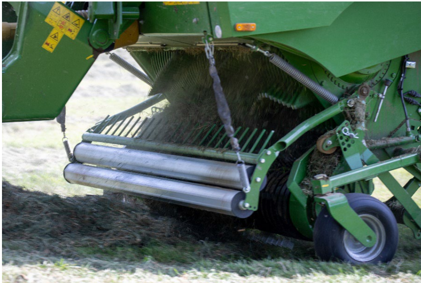
Photo : pression d'appui uniforme, grâce à la décharge mécanique du pick-up
