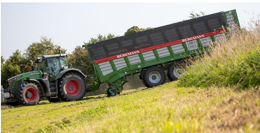
Photo : ramassage impeccable du fourrage, grâce au pick-up oscillant
